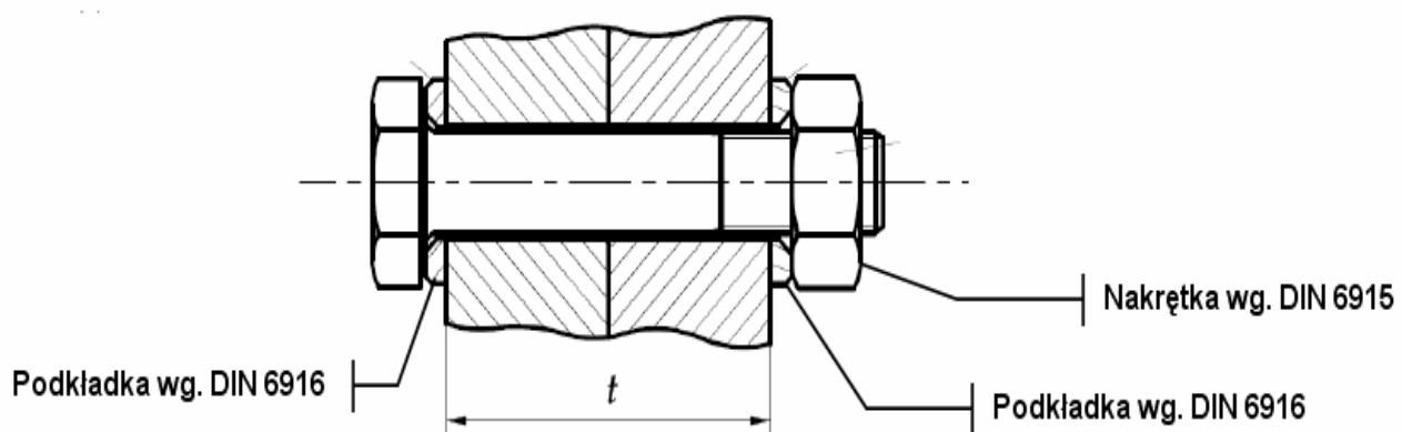
**Śruba z łączem sześciokątnym powiększonym do połączeń sprężanych HV**
